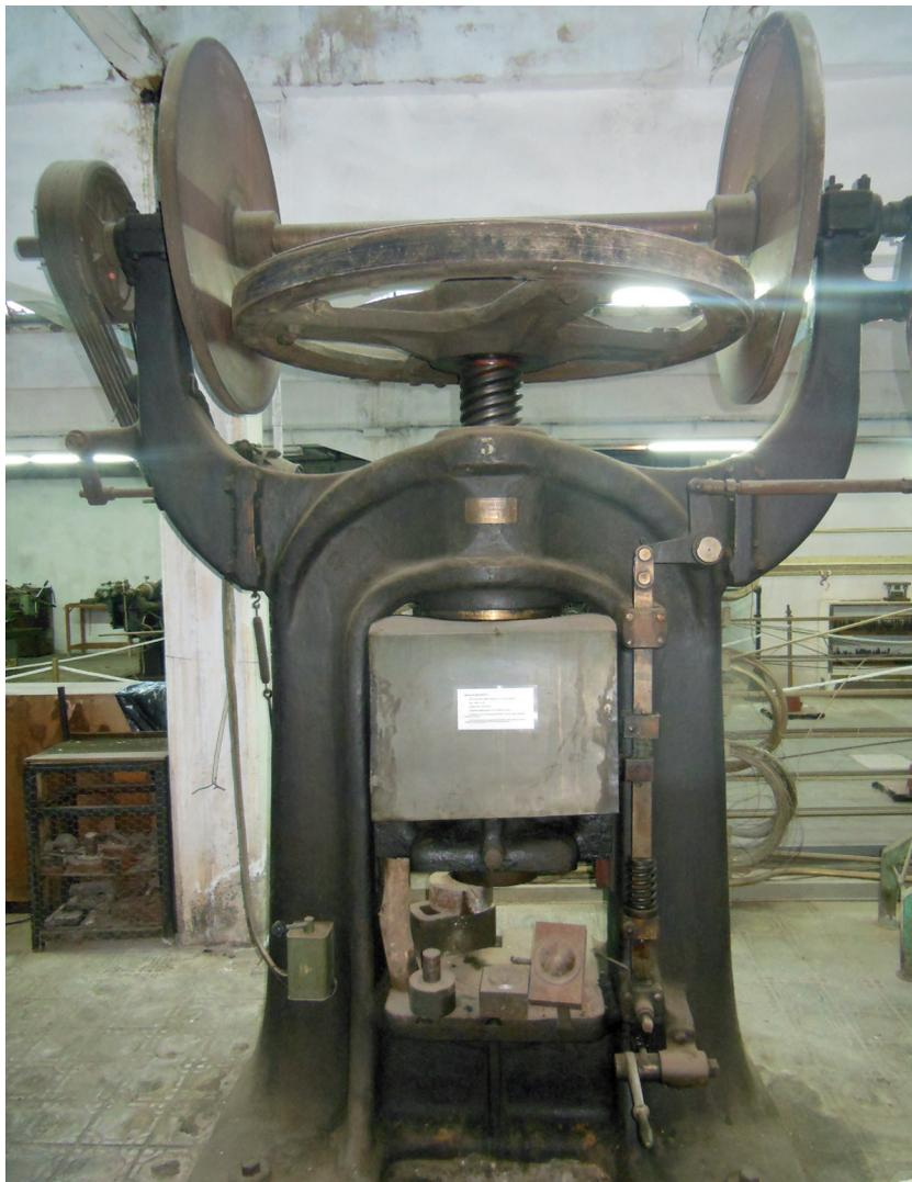
*Figura 6.- Prensa de fricción para estampado y troquelado de piezas. Llegó a Riópar en 1830. Fabricante Weingarten de Wurtemberg (Alemania).*
