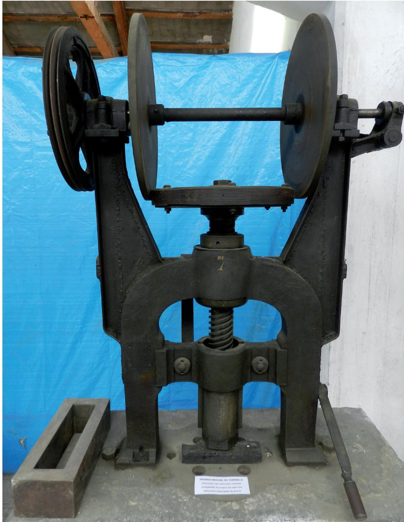
*Figura 5.- Prensa manual de tornillo para el estampado de piezas. Fabricada a principio del siglo XIX por fabricante desconocido. Ubicación actual: Riópar (Albacete).*
