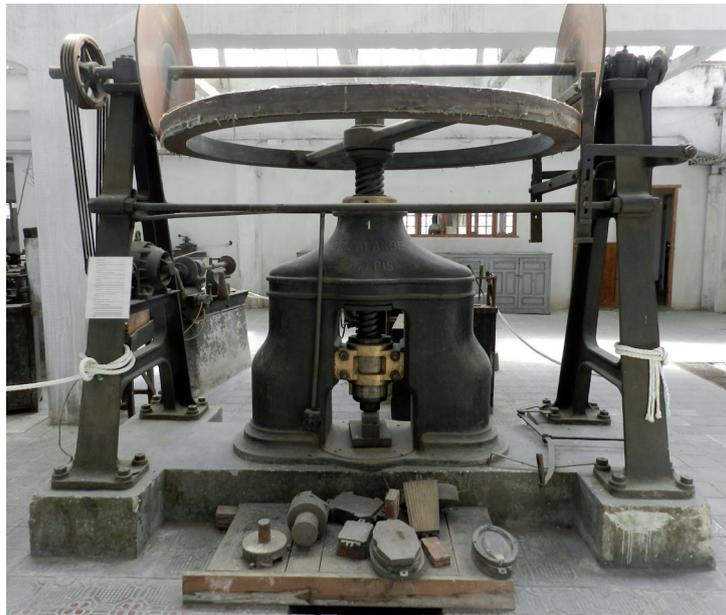
Figura 2.- Prensa de fricción para estampar y cortar planchas de latón. Fabricante Delalande (París) 1808. Ubicación actual: Riópar (Albacete).
